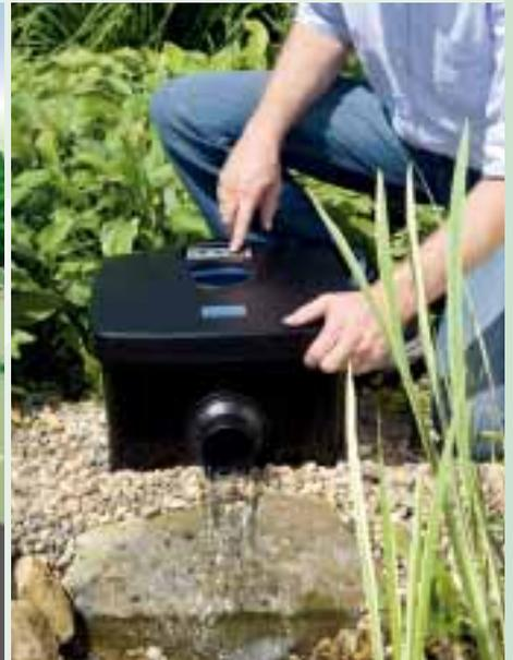
**DURCHLAUFFILTER** werden bei mittelgroßen bis großen Teichen oder kleinen Koiteichen verwendet. Sie stehen oberhalb des Wasserspiegels am Teichrand oder oberhalb eines Bachlaufs, sodass das Wasser drucklos zurück in den Teich fließt.
