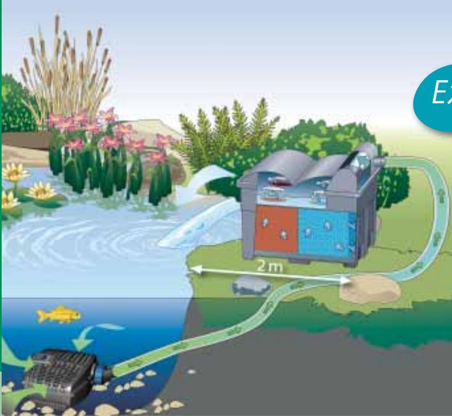
Schematische Darstellung: BioSmart Set Komponenten in Funktion
